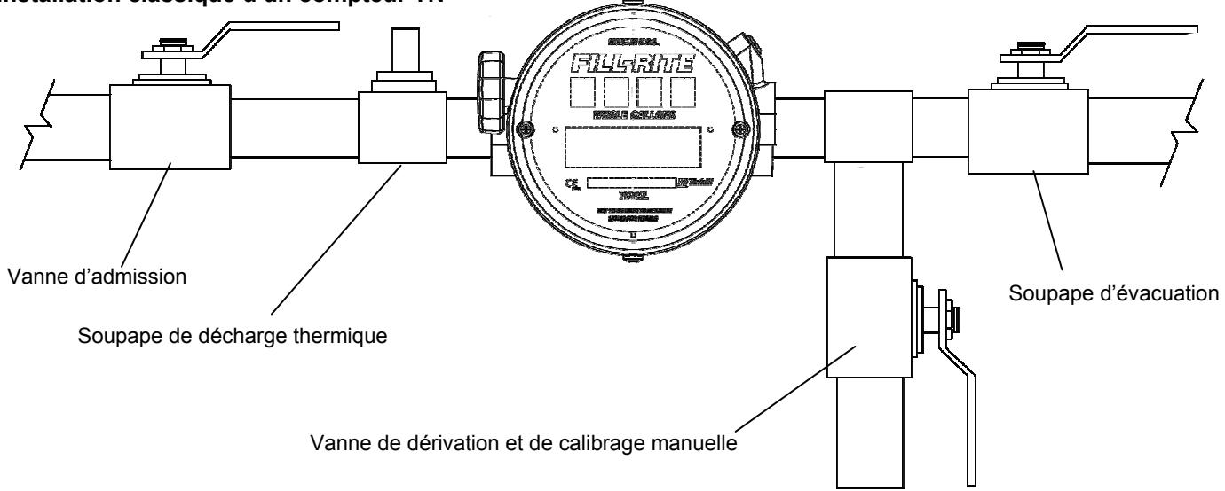
Les compteurs à déplacement positif sont conçus pour fonctionner avec le plein de liquide. Le compteur doit être installé dans un emplacement toujours **plein de liquide**. Il peut être installé dans les lignes verticales à condition que le liquide s'écoule vers le haut.
