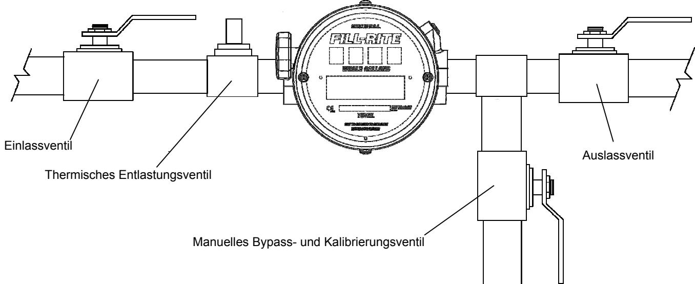
Direktverdrängungs-Zähler (PD) sind zum Betrieb mit Flüssigkeitskomplettfüllung vorgesehen. Der Zähler muss an einer Stelle eingebaut werden, an der er immer mit **Flüssigkeit gefüllt** ist. Er kann in senkrechte Leitungen eingebaut werden, solange die Strömung nach oben gerichtet ist.
