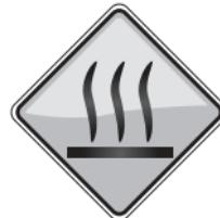
Bij langdurig gebruik kan de motorbehuizing warm worden. Langdurig contact met de huid kan brandwonden veroorzaken.
