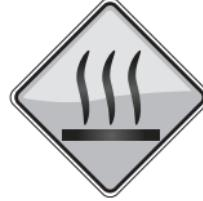
La carcasa del motor puede calentarse durante el funcionamiento por períodos largos. El contacto prolongado con la piel puede causar quemaduras.
